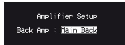
Если тыловые акустические системы окружающего звука не используются в основной зоне, то каналы их усилителя могут быть назначены для тылового канала основной зоны, фронтального канала основной зоны (Bi-Amp) и мультизонного использования.
