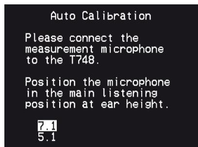
Звук в положении для прослушивания настраивается с помощью входящего в комплект микрофона. В зависимости от наличия наушников, вы можете выбрать конфигурацию 7.1 или 5.1. После выбора конфигурации 7.1 или 5.1 запускается автоматическая калибровка. Этапы автоматической калибровки каждого параметра отображаются на экране.
